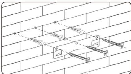
Просверлите отверстия 3×8 мм для крепления кронштейна. Прикрутите и затяните кронштейн на стене с помощью винтов и пластиковых дюбелей, входящих в комплект.
