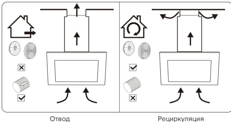
Если у вас есть выход наружу, вытяжку можно подключить, как показано на рисунке выше, с помощью трубы (с внутренним диаметром 150 мм).
