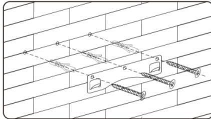
Просверлите отверстия  $3 \times 8$  мм для крепления кронштейна. Прикрутите и затяните кронштейн на стене с помощью винтов и пластиковых дюбелей, входящих в комплект.
