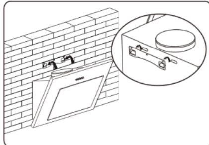
Поднимите вытяжку и повесьте ее на настенный крючок.
