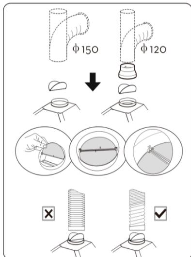
**Способ установки для трубы диаметром 150 мм:** вставьте обратный клапан, как показано на рисунке, и закрепите трубу.
