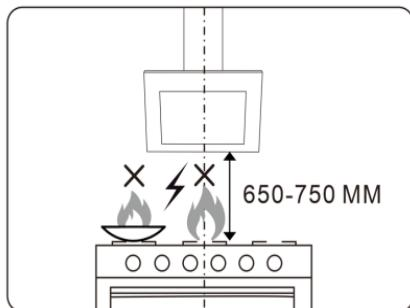
Для достижения наилучшего эффекта вытяжку следует размещать на расстоянии 650–750 мм от варочной поверхности.
