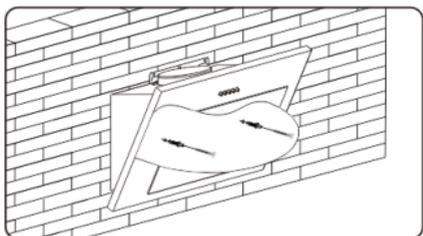
Перед установкой необходимо просверлить 2 дополнительных отверстия × 8 мм и вставить крепежные винты и пластиковые дюбели.
