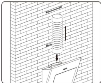
Закрепите односторонний клапан на воздуховыпускном отверстии вытяжки, а затем присоедините трубу к воздуховыпускному отверстию, как показано на рисунке.
