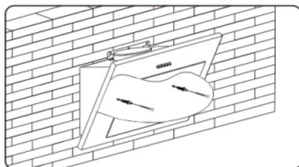
Перед установкой необходимо просверлить 2 дополнительных отверстия  $\times 8$  мм и вставить крепежные винты и пластиковые дюбели.
