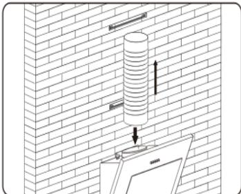
Закрепите односторонний клапан на воздуховыпускном отверстии вытяжки, а затем присоедините трубу к воздуховыпусканому отверстию, как показано на рисунке.
