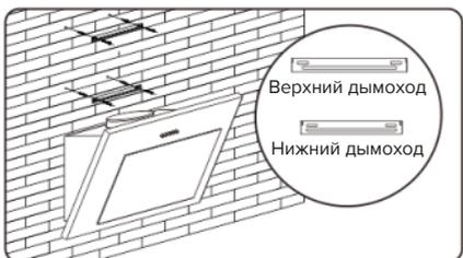
Отметьте положение и просверлите по 2 отверстия для каждого кронштейна дымохода и затяните кронштейн винтами.
