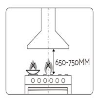
Для достижения наилучшего эффекта вытяжку следует размещать на высоте 650–750 мм над варочной панелью.
