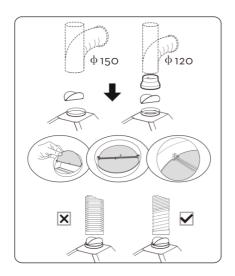
Способ монтажа воздуховода диаметром 150 мм.: вставьте антивозвратный клапан, как показано на рисунке, и закрепите трубу воздуховода.
