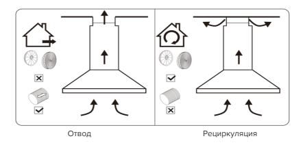
Если у вас есть выход наружу, вытяжку можно подключить, как показано на рисунке выше, с помощью воздуховода (внутренним диаметром 150 мм).
