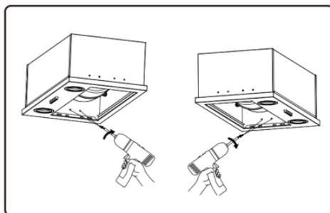
Если с обеих сторон боковой панели имеются деревянные доски, можно закрепить ее с помощью саморезов, чтобы укрепить вытяжку (по два с каждой стороны).
