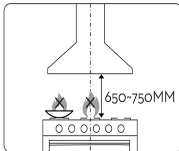
Для достижения наилучшего эффекта вытяжку следует размещать на расстоянии 650–750 мм от варочной поверхности.
