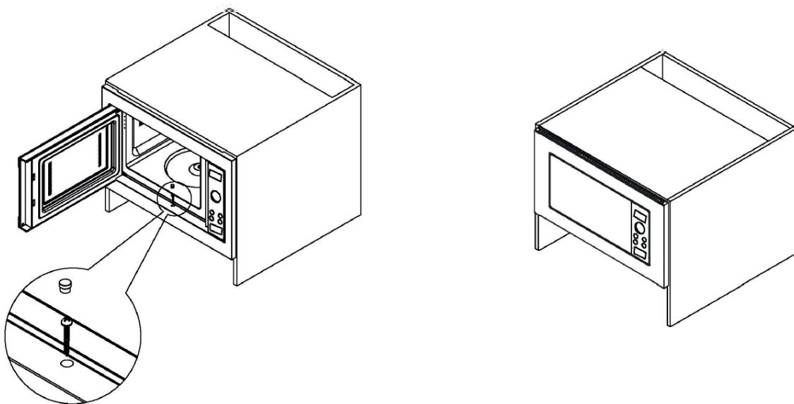
2. Откройте микроволновую печь, закрепите болт (компонент 3) и прикрутите его к корпусу, затем установите винтовую крышку.
