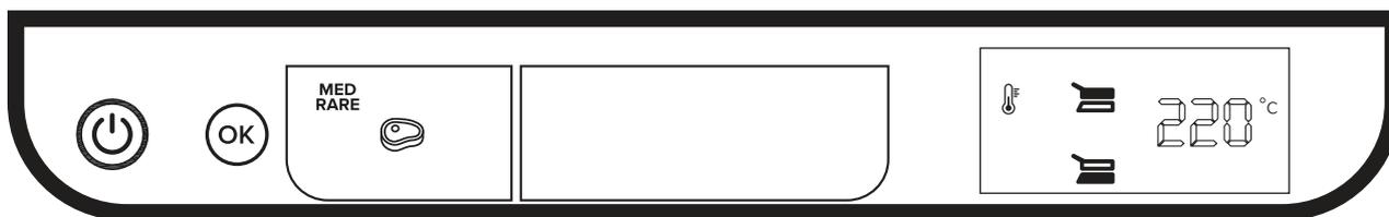
**текущая температура пластин и обратный отсчёт времени приготовления**
