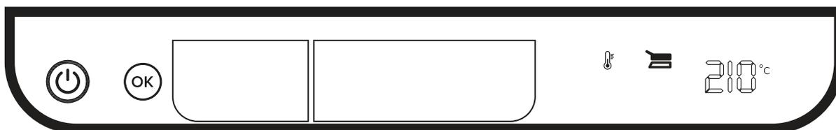
**Попеременное отображение текущей температуры каждой пластины и обратного отсчёта времени приготовления.**
