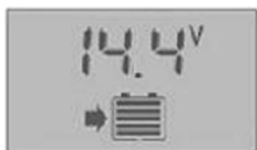
2 - напряжение поддерживающего (капельного) заряда
