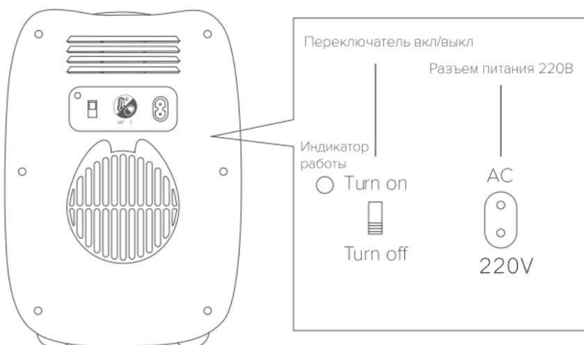
Для включения холодильника переведите переключатель “On/Off” на задней стенке в положение ON. Для Выключения — переведите переключатель “On/Off” на задней стенке в положение OFF.
