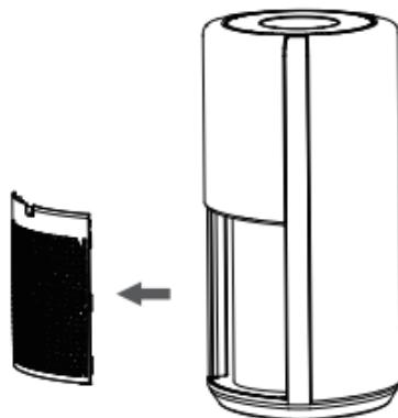
2. Выньте фильтр и шнур (адаптер) питания из корпуса устройства.
