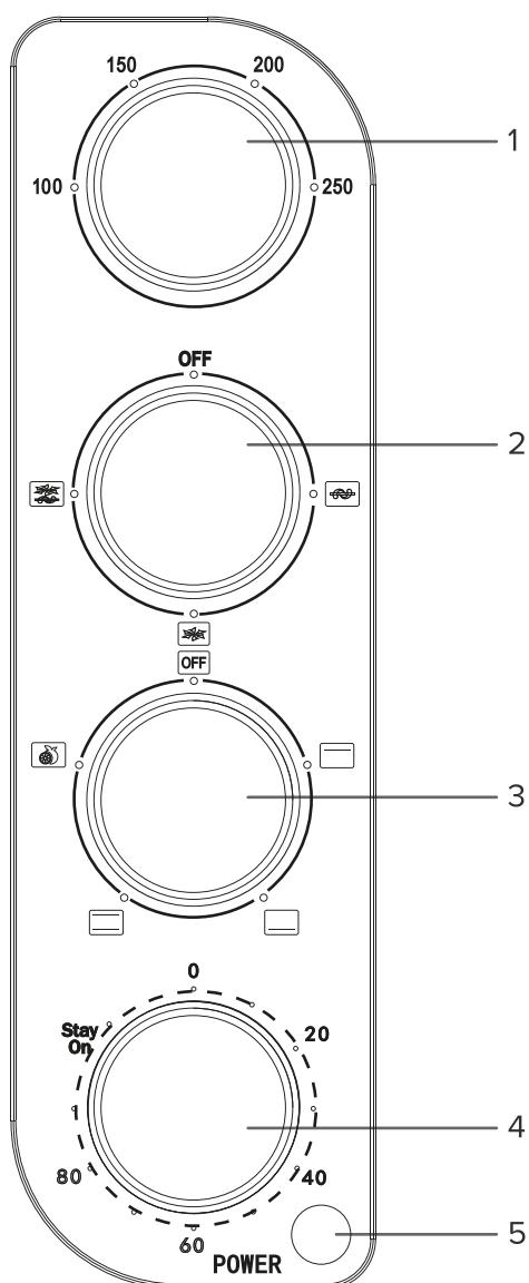
1 — регулятор температуры. Поворотом этой рукоятки регулируется температура приготовления во всех режимах, кроме сушки.
