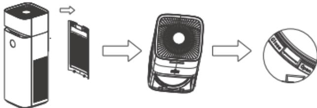
2. Откройте заднюю крышку и поверните держатель фильтра в положение «open».
