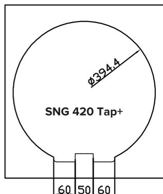
Разместить мойку в установочном отверстии, предварительно уложив уплотнительную ленту по периметру мойки.
