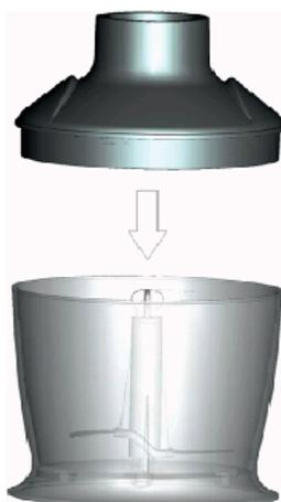
Закрепите блок двигателя на чаше измельчителя.
