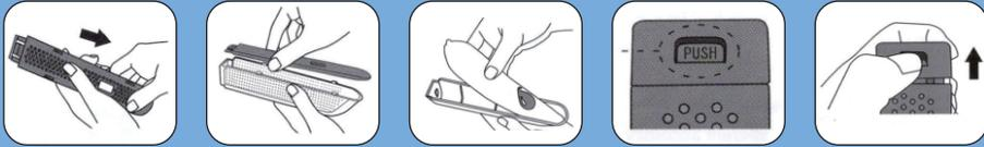
Затем поместите его в пластиковый корпус ④. Убедитесь, что содержимое осушающего элемента равномерно распределено для достижения наилучших результатов. Индикатор влажности должен располагаться лицевой стороной вверх, чтобы он был виден через окошко с пластиковыми панелями
